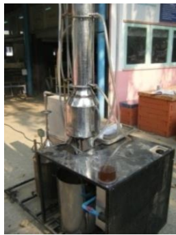
รูปที่ 1 เครื่องกลั่นน้ำมันเชื้อเพลิงจากน้ำมันเครื่องที่ใช้แล้ว
