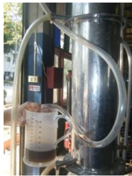
รูปที่ 1 เครื่องกลั่นน้ำมันเชื้อเพลิงจากน้ำมันเครื่องที่ใช้แล้ว
