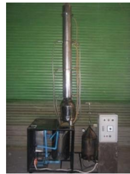
รูปที่ 1 เครื่องกลั่นน้ำมันเชื้อเพลิงจากน้ำมันเครื่องที่ใช้แล้ว
