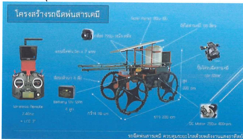
รูปที่ 3 แสดงโครงสร้างรถฉีดพ่นสารเคมีควบคุมระยะไกลด้วยพลังงานแสงอาทิตย์
