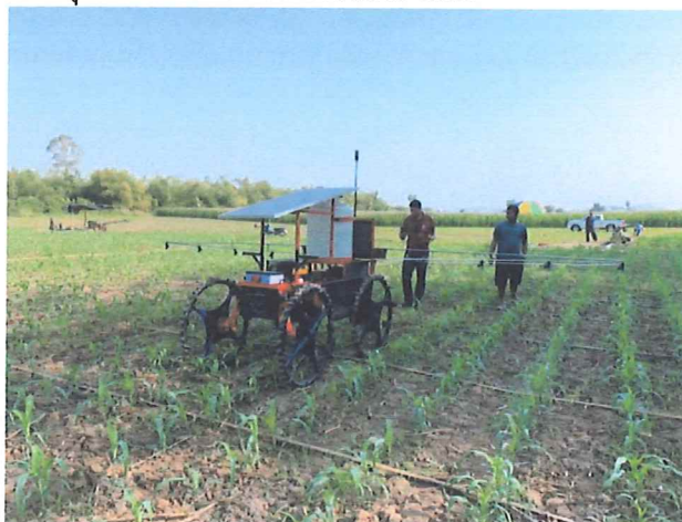
รูปที่ 4 แสดงการทดลองรถฉีดพ่นสารเคมีควบคุมระยะไกลด้วยพลังงานแสงอาทิตย์พ่นปุ๋ย ทางใบในแปลงเพาะปลูกข้าวโพด
