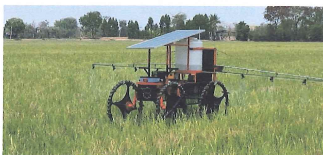
รูปที่ 5 แสดงการทดสอบประสิทธิภาพรถฉีดพ่นสารเคมีควบคุมระยะไกลด้วยพลังงานแสงอาทิตย์ในนาข้าว
