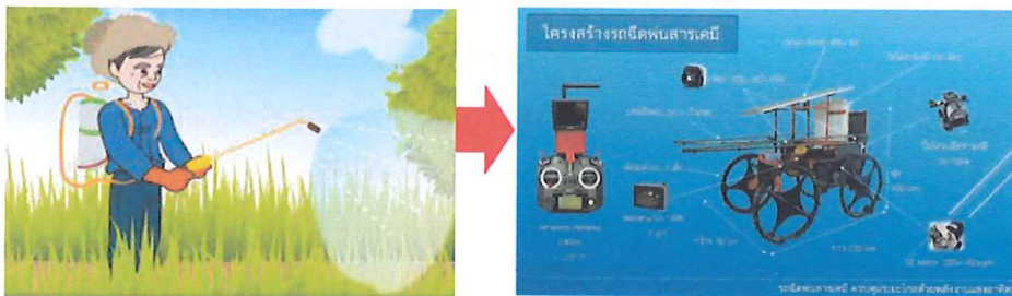
รูปที่ 1 แสดงแนวคิดรถฉีดพ่นสารเคมีควบคุมระยะไกลด้วยพลังงานแสงอาทิตย์
