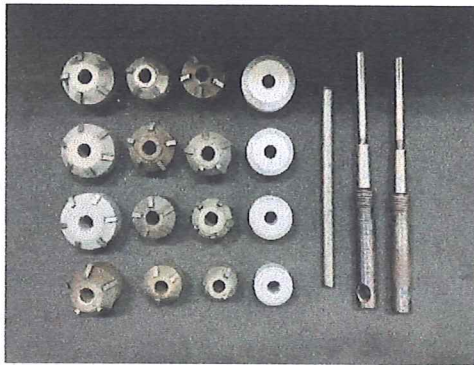
รูปที่ 1.2 ชุดเจียร์บ่าวาล์วรถจักรยานยนต์
