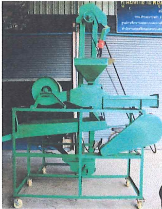
ภาพที่ 3 แสดงตัวเครื่องตัดแยกขนาดข้าวกล้องของชุมชนหนองปั้งไก่อ จังหวัดกำแพงเพชร
